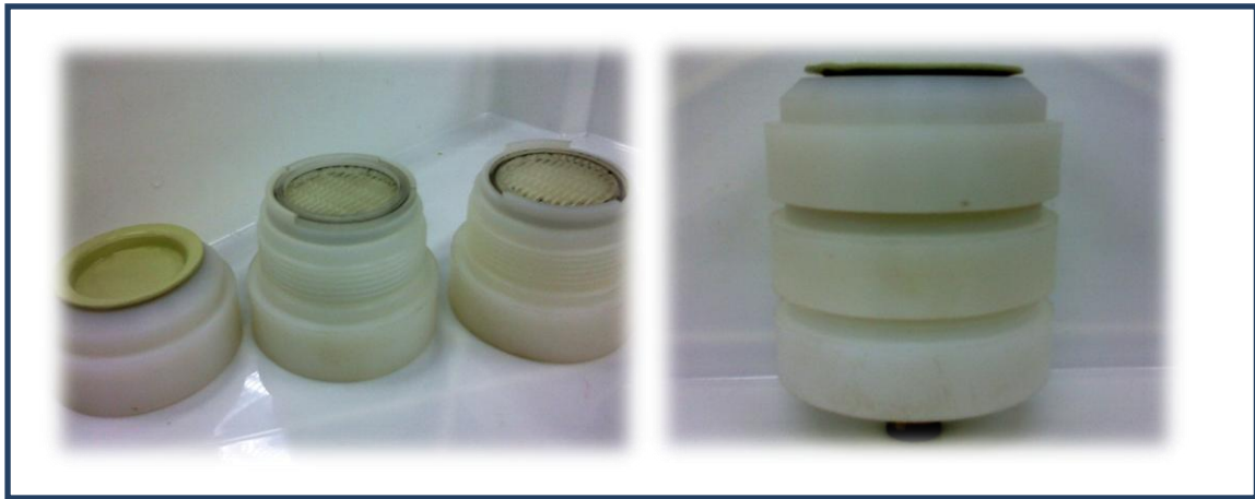
Figura 3: Porta filtro desmontado e Porta filtro montado; Autora: Mariana de A. Souza (16/07/2012)
